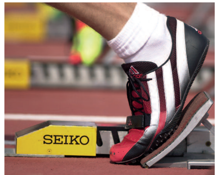
Der Startblock misst die Zeit zwischen Schuss und Start des Athleten, um Fehlstarts zu erkennen. Foto: AMS_Dentsu
