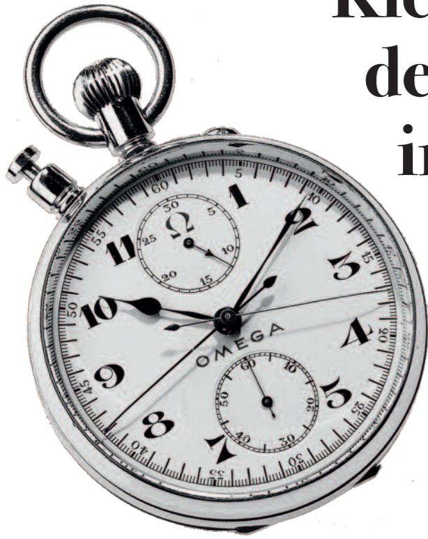
Bei den Olympischen Spielen in Los Angeles 1932 eingesetzte Stoppuhr mit einer Messgenauigkeit von 1/5 Sekunde. Foto: OMEGA
